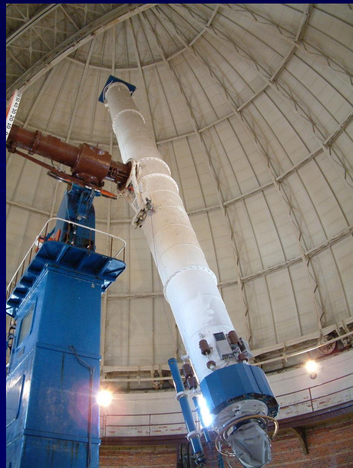
Самый большой телескоп-рефрактор имеет диаметр 1 метр.
