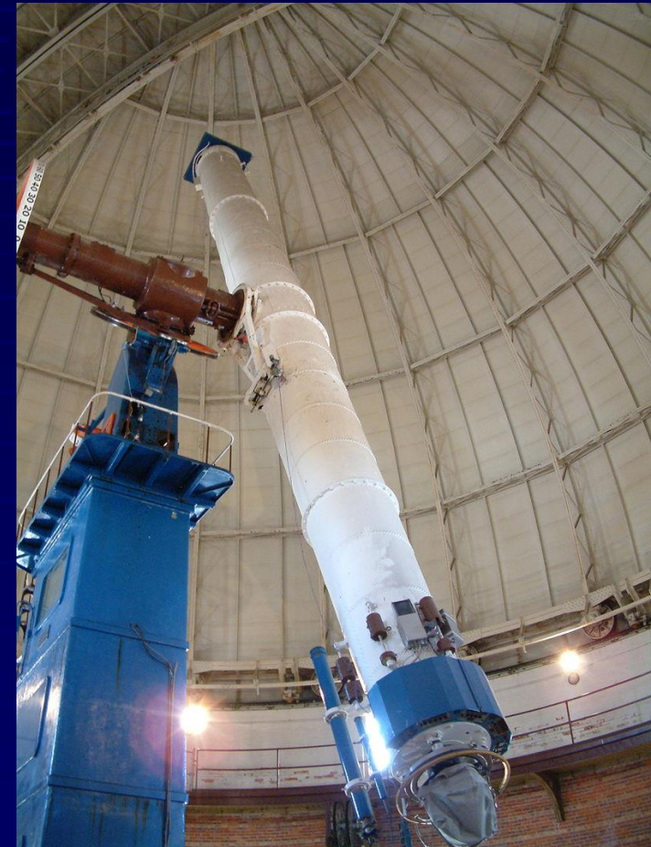
Самый большой телескоп-рефрактор имеет диаметр 1 метр.
