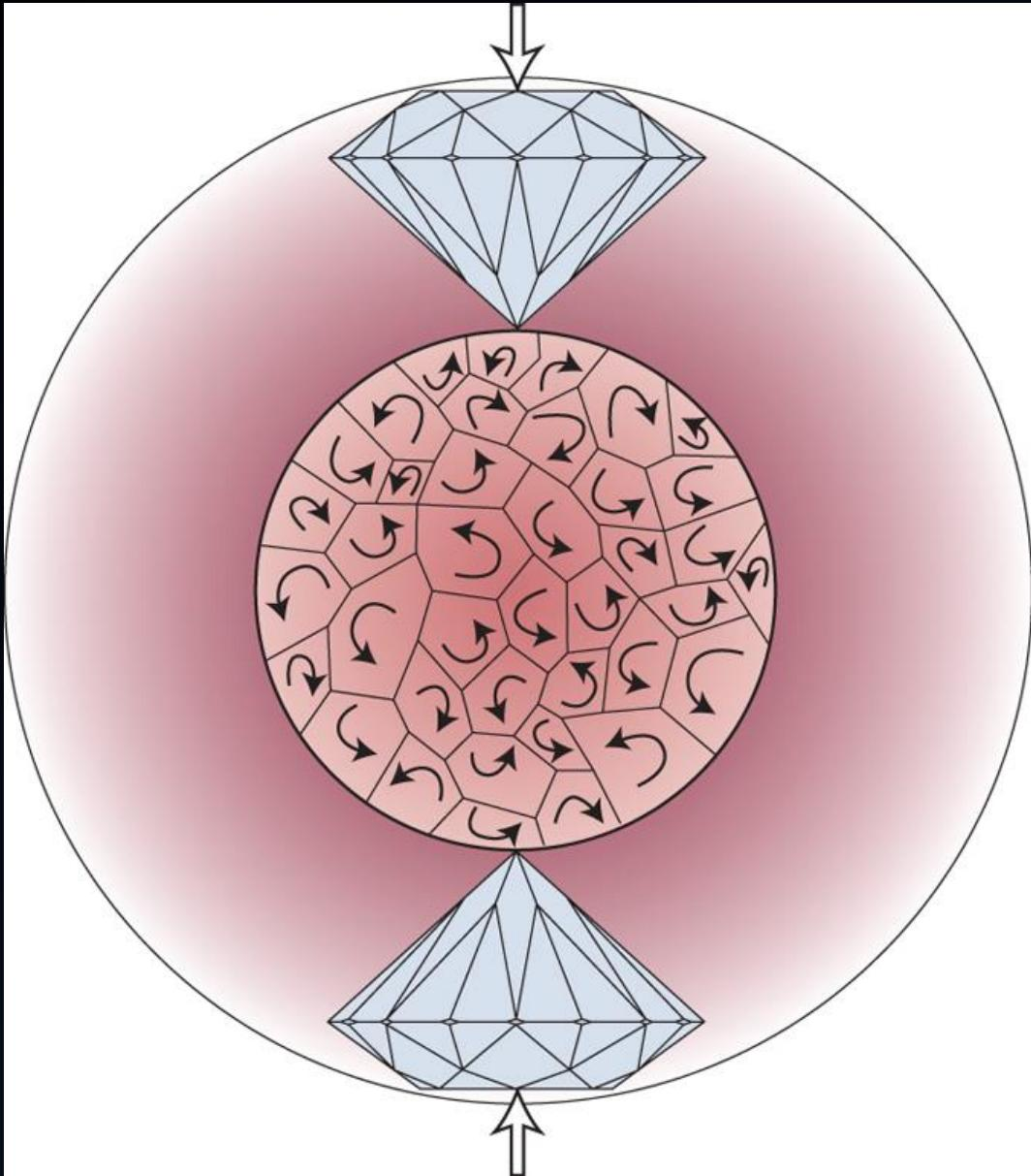
В лабораторных экспериментах уравнение состояния изучают, сжимая вещество в алмазных ячейках. Но пока достичь высоких плотностей и температур не получается. На помощь приходит моделирование.
