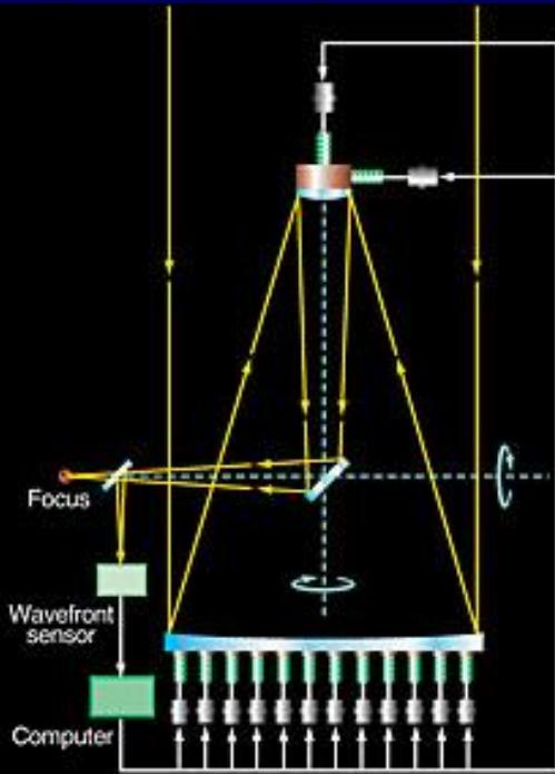
Изменение параметров главного зеркала с частотой менее 1 Гц для компенсации различных изменений его формы.
